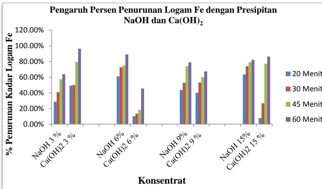
Gambar 5. Pengaruh Persen Penurunan Logam Fe dengan Presipitan NaOH dan  $\text{Ca(OH)}_2$
